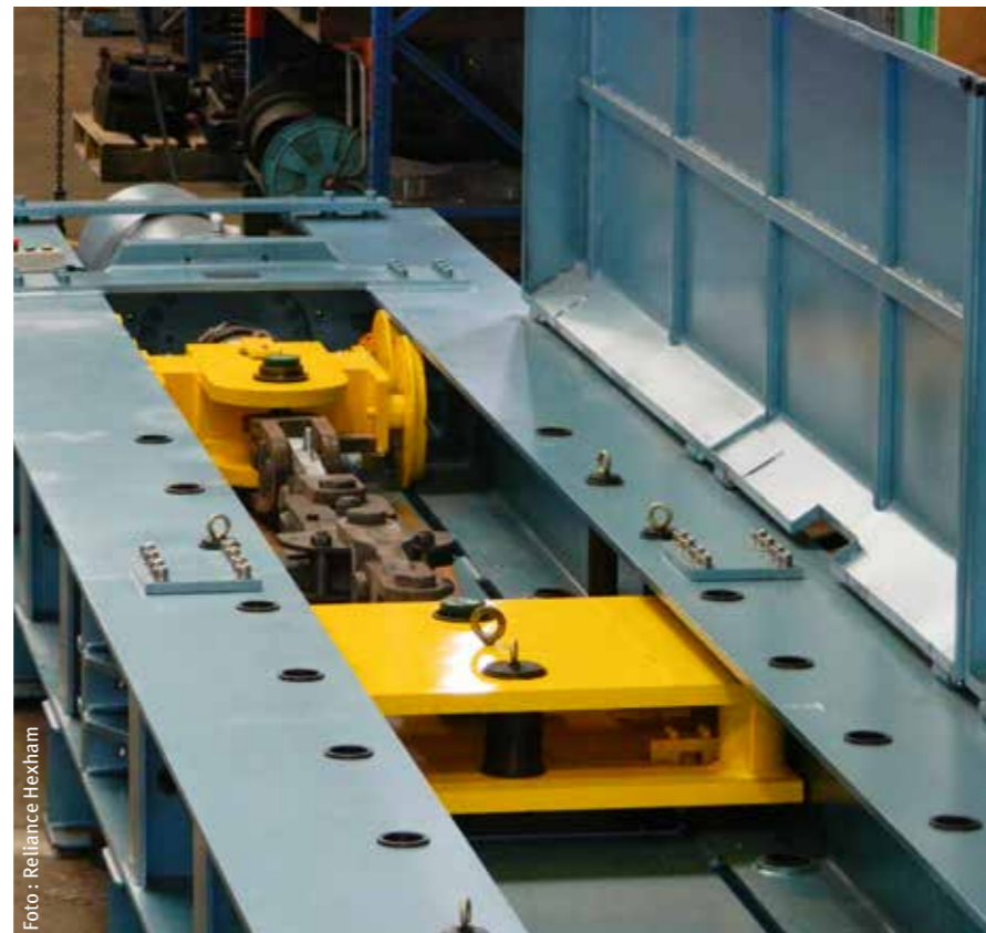
El equipo de pruebas de 200 t utilizado para realizar pruebas destructivas y cargas de prueba para la validación de diseño.
